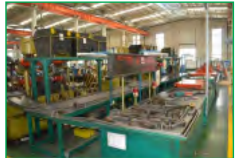
Assemblaggio, verifica in linea, precarico e lubrificazione- Stazione "lean production" Assembly, online inspection, preload and lubrication-lean production line
