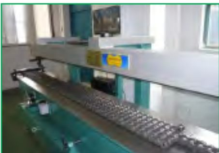
Misuratore di precisione della lunghezza della catena Chain length precision measuring instrument
