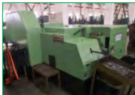
Intestatura rulli a freddo Cold heading pin machine
