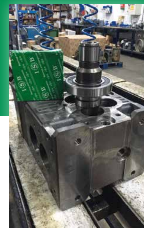
A sinistra, il tornio in funzionamento e a destra un motoriduttore della serie CROM e il cuscinetto 6212-2RS ISB.
